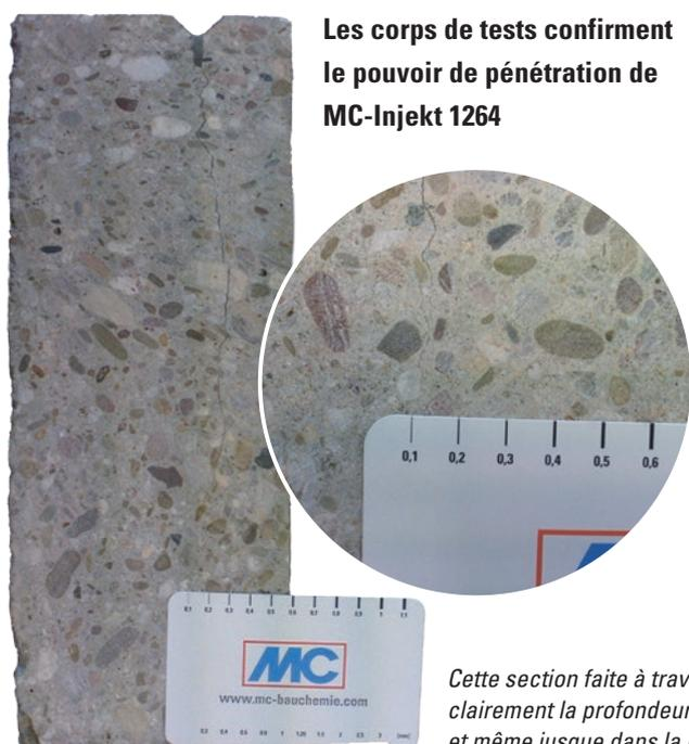
*Cette section faite à travers un élément injecté nous montre clairement la profondeur de pénétration de MC-Injekt 1264 compact, et même jusque dans la partie la plus fine de la fissure*
