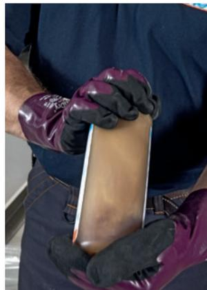
4. Agitez jusqu'à obtention d'un liquide homogène (coloris opaque crème).
